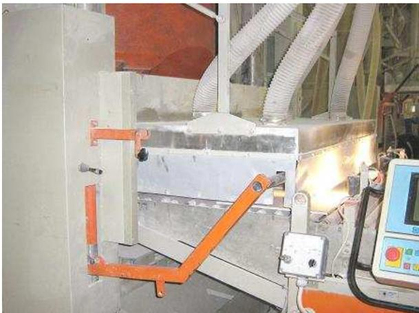
Zona di pressatura (uscita): ampia cappa, fornita adeguatamente di calate per l'aspirazione.
