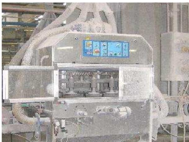
Trattamento della superficie con "spatolatrice". Trattamento di "multispazzolatura" della superficie.
