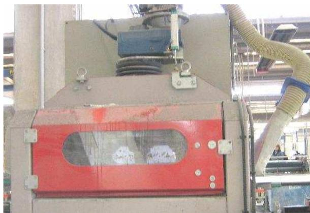
Apparecchiatura cabinata e aspirata per la spolveratura delle piastrelle: linea e particolare.
