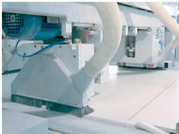
Dimensionatura e rifilatura eseguite sotto aspirazione: particolari all'interno di cabinatura.
