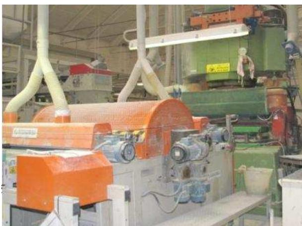
Aspirazione delle polveri dopo pulitura delle piastrelle.
