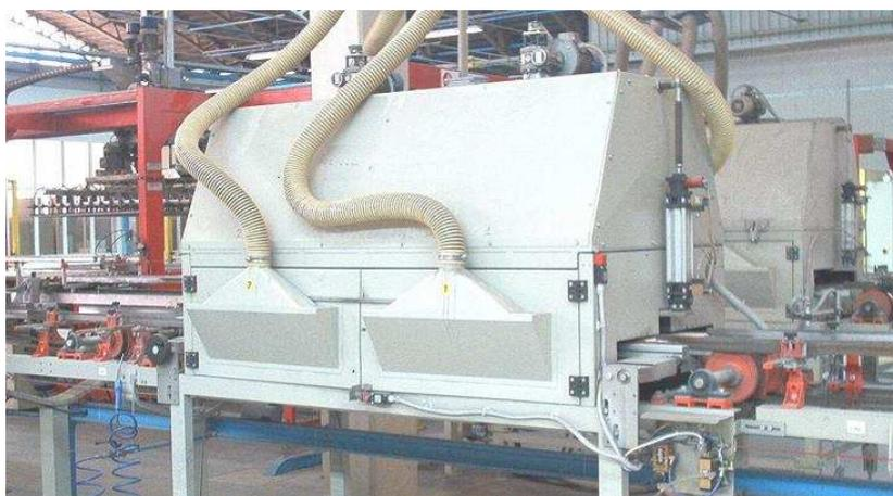
Apparecchiatura multispazzola chiusa, con aspirazione localizzata, per la "lucidatura" delle piastrelle.
