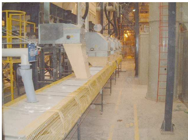
Sopra: Nastro collettore carterato per racchiudere le polveri alimentate da coclee e altri nastri.
