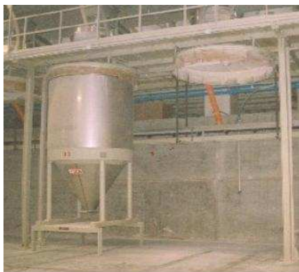
Trasporto mediante sili mobili: fasi di carico sili, trasporto sili, alimentazione pressa.
