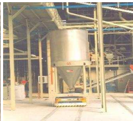
Trasporto mediante sili mobili: fasi di carico sili, trasporto sili, alimentazione pressa.
