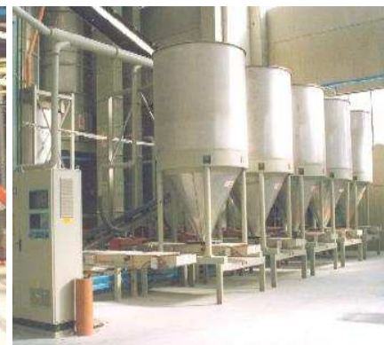
Trasporto mediante sili mobili: fasi di carico sili, trasporto sili, alimentazione pressa.
