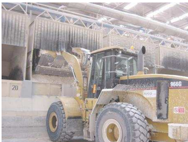
Box di stoccaggio. Pala meccanica climatizzata, per il riempimento tramogge, con filtro del particolato.
