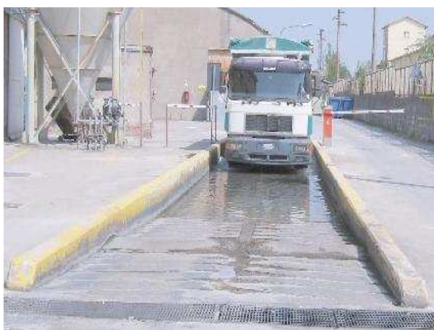
Sistema di pulizia ad umido delle ruote
